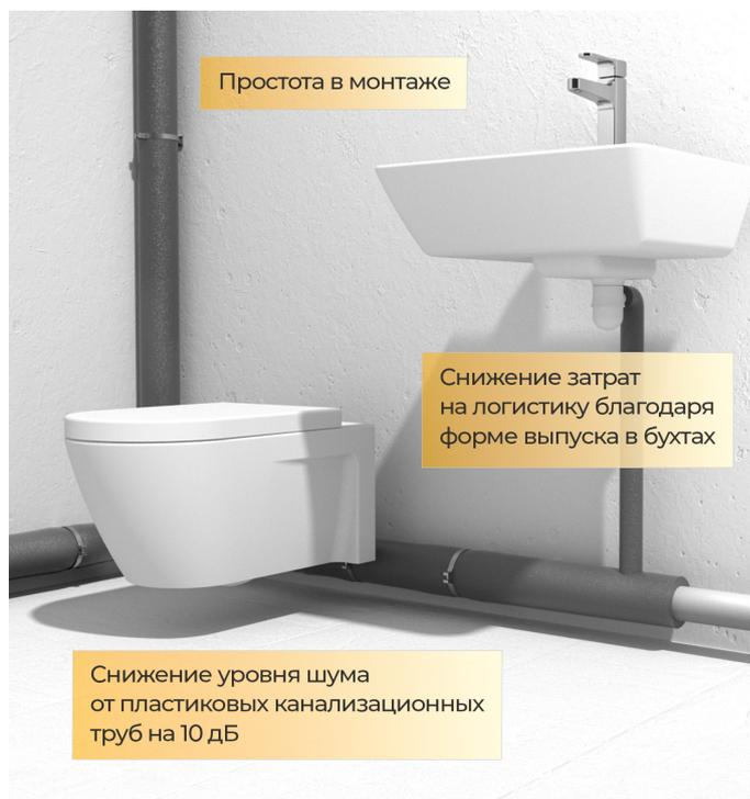
Зубчатый профиль внутренней поверхности и высокая плотность материала позволяют значительно снижать шумы в санитарных системах. Согласно исследованиям, проведенным в Fraunhofer Institute for Building Physics (Штуттгарт, Германия) в соответствии с EN 14366, применение Energoflex® Acoustic позволяет снизить уровень шума от пластиковых канализационных труб на 10 дБ.
