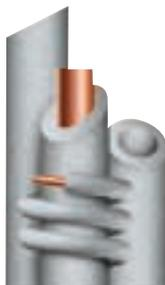
**Технические характеристики:** коэффициент теплопроводности  $\lambda$ , при 20 °С — 0,039 Вт/(м·К); фактор сопротивления диффузии водяного пара,  $\mu$  — не менее 3000; температурные пределы применения — от -40 до +70 °С; коэффициент звукопоглощения в диапазоне частот 250–6300 Гц — от 11 до 78%; сопротивление расслаиванию алюминиевой фольги и пенополиэтилена — не менее 10 Н/м; толщина алюминиевой фольги — не менее 14,0 мкм.
