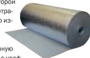
Технические характеристики: коэффициент теплопроводности  $\lambda$ , при 20 °С — 0,039 Вт/(м·К); температурные пределы применения — от –40 до +100 °С; группа горючести — Г1; коэффициент звукопоглощения в диапазоне частот 250–6300 Гц — от 11 до 78%; сопротивление расслаиванию алюминиевой фольги и пенополиэтилена — не менее 10 Н/м; толщина алюминиевой фольги — не менее 14,0 мкм.
