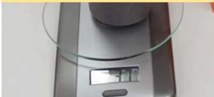
Вес образца — 37 граммов. Изоляция имеет высокую плотность порядка 35–40 кг/м<sup>3</sup>. Высокая плотность гарантирует высокие энергосберегающие и механические свойства теплоизоляции.
