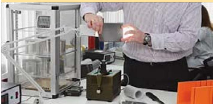
Изоляция не прозрачна не только для видимого спектра, но и для теплового излучения. Непрозрачность достигается за счёт высокой плотности пены и специальных отражающих теплового излучение добавок.
