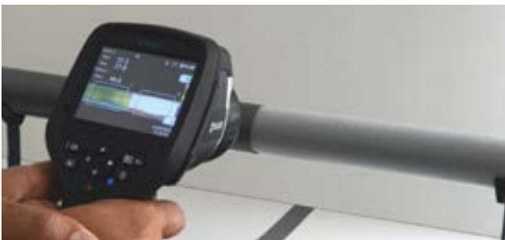
Снимок, сделанный тепловизором. На одну и ту же трубу установлены: с левой стороны – трубка Energoflex® Super; с правой стороны – дешёвая изоляция.
