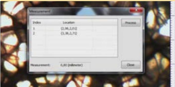
Средний размер ячеек 0,8 мм. Ячеистая структура однородная. Такая пена имеет наилучшие теплозащитные и механические свойства.
