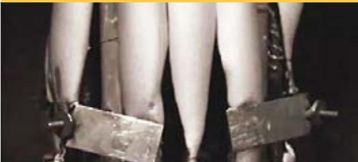
В рецепте сырья присутствует антипирен, в составе которого есть специальная добавка («антидроп»), образующая при горении твёрдую корочку на поверхности изоляции. Эта корочка препятствует образованию капель. Изоляция не поддерживает самостоятельного горения (самозатухающая). Изоляция имеет минимальную потерю массы и минимальные повреждения по длине.
