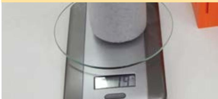
Вес образца — 19 граммов. Изоляция имеет плотность в диапазоне 20–25 кг/м<sup>3</sup>. Это происходит по двум причинам. Первая — недобросовестный производитель экономит на сырье. Вторая — дешёвое оборудование неспособно выпускать продукцию с высокой плотностью.
