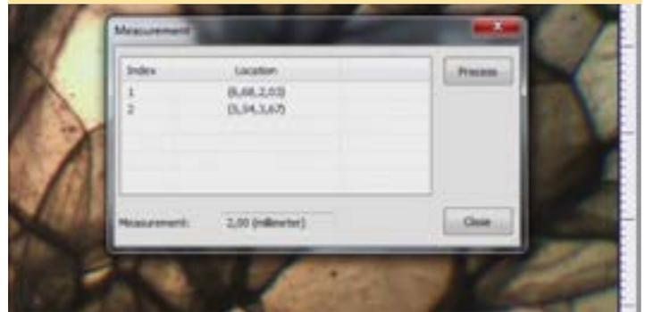
Размер ячеек 2–2,5 мм. Это в 2,5–3 раза больше! Ячеистая структура крайне неравномерна. Изоляция с такой структурой слабо сохраняет тепло, имеет большую усадку при нагреве и плохо клеится.
