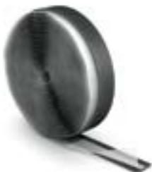
Лента демпферная Energofloor® предназначена для компенсации температурного расширения цементной стяжки в системах отопления типа «тёплый пол». Полиэтиленовая плёнка служит для предотвращения затекания жидкого цементного раствора под нижнюю кромку ленты.
